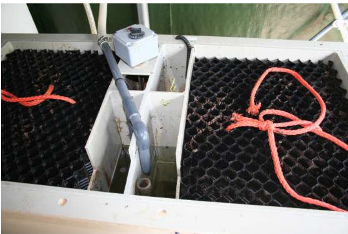
Foto 2: struttura in plastica per sostenere il biofilm microbico
