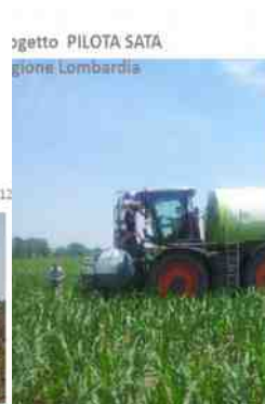
Incorporazione degli effluenti/digestati al suolo
