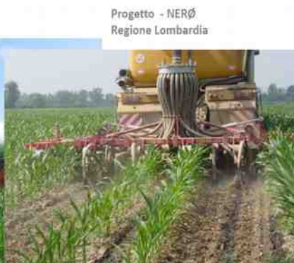
Incorporazione degli effluenti/digestati al suolo
