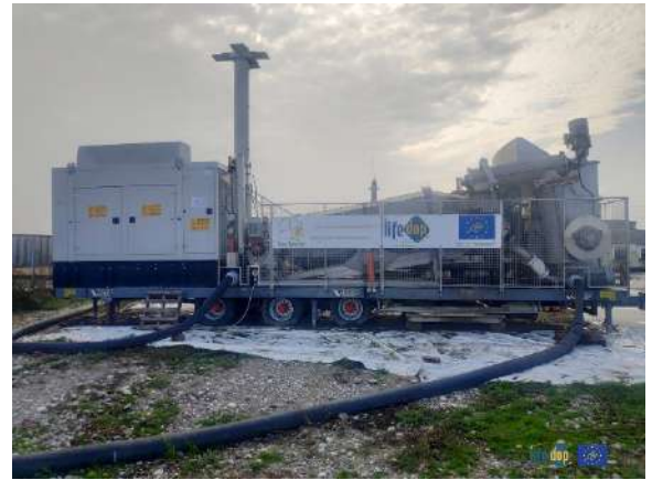
Figura 1: Cavizzatore mobile: il prototipo, realizzato nell'ambito di LIFE DOP, è un dispositivo che attraverso la vagliatura, triturazione, cavitazione dei reflui (liquami e letami) agevola la valorizzazione nella filiera della digestione anaerobica (foto: staff LIFE DOP)
